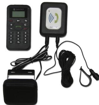
Беспроводная клавиатура имеет цифровые клавиши для набора номера, крупные кнопки ответа и завершения вызова, регулировки громкости. Отдельно стоит отметить наличие кнопки передачи тревожного сигнала «SOS». На алфавитно-цифровом ЖК-дисплее отображается вызываемый номер, состояние устройства, уровень заряда батареек (в клавиатуре используются две батарейки AA). При нажатии клавиш клавиатура подсвечивается изнутри, обеспечивая комфортный набор в сумерки и ночное время.
