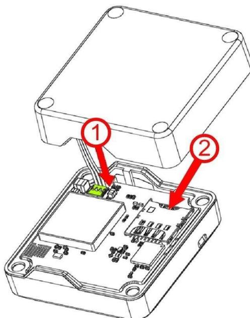
Для установки SIM-карты открутите прилагаемой отверткой четыре болта на нижней части корпуса. После этого подключите внутренний аккумулятор, установите SIM-карту в слот скошенным углом внутрь и прикрутите крышку обратно.
