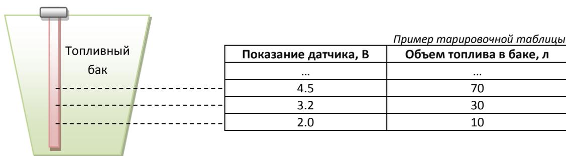
Для составления таблицы обычно используется цифровой вольтметр. Полученная тарировочная таблица вносится пользователем самостоятельно через WEB-интерфейс системы мониторинга либо через специалистов Службы поддержки.
