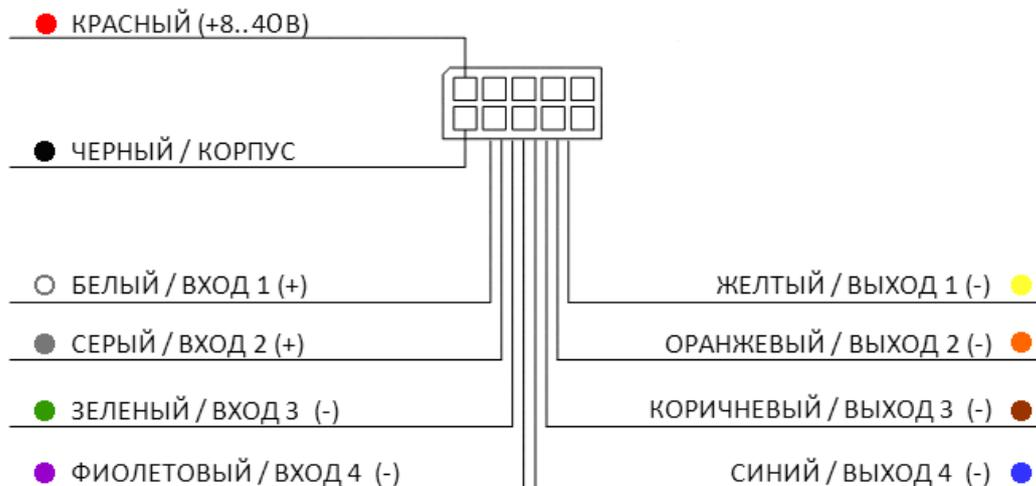
Шлейф состоит из 8 цветных проводов и имеет разъем на конце. В следующих таблицах указано назначение проводов и контактов.
