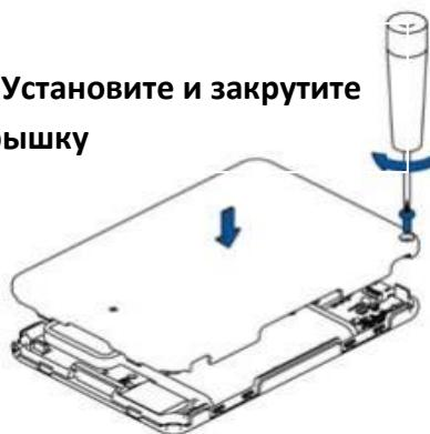
Для установки SIM-карты открутите отверткой болты на нижней части корпуса. После этого установите SIM-карту в слот скошенным углом внутрь, подключите внутренний аккумулятор и прикрутите крышку обратно.
