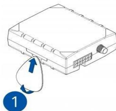
Установите SIM-карту в слот SIM1 (скошенным углом наружу), снимите нижнюю крышку, подключите резервный аккумулятор к специальному разъему на нижней части платы, после чего закройте обе крышки.
