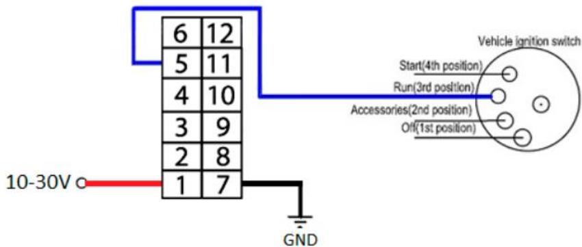
Кроме того, можно контролировать сигнал «Зажигание», найдя любой источник положительного сигнала, который работает только при включенном зажигании, например, источник питания автомагнитолы.
