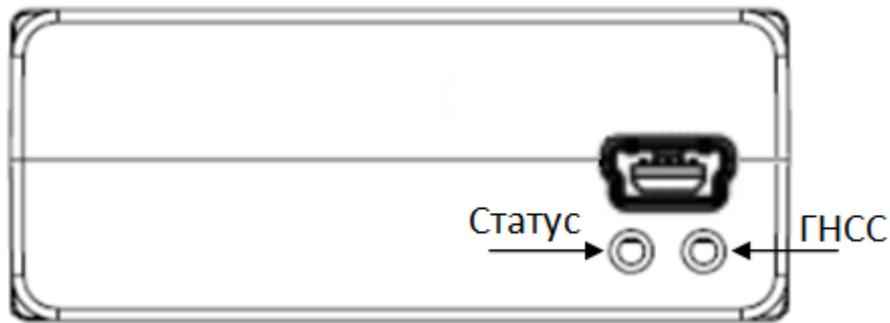
Для быстрой проверки качества приема сигналов GPS и GSM, а так же состояния устройства используются светодиодные индикаторы. Статус определяется по характеру их свечения:
