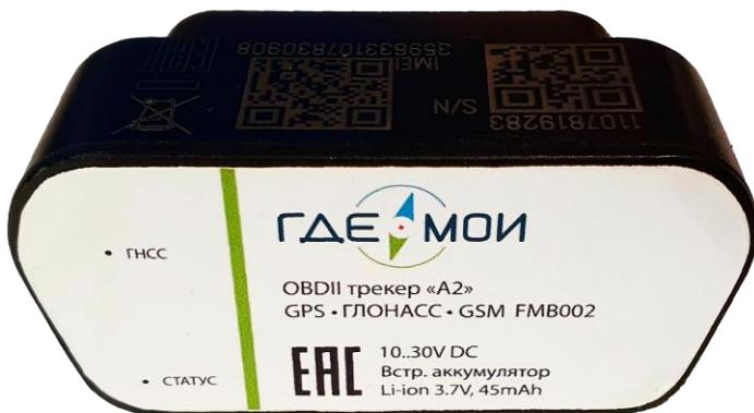
Для быстрой проверки качества приема сигналов GPS и GSM, а также состояния устройства используются светодиодные индикаторы. Статус определяется по характеру их свечения:
